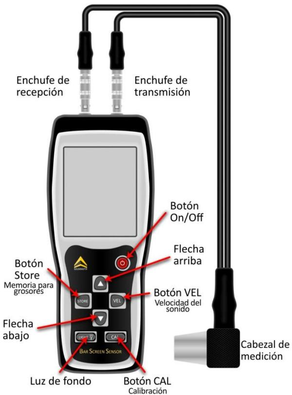
El analizador ultrasónico está controlado por un microprocesador y permite medir de forma rápida y precisa el grosor y la velocidad del sonido de los materiales. Para el acoplamiento entre el cabezal de medición y el objeto de prueba, el BarScreenSensor-Set contiene 100 mL de gel de ultrasonido.
