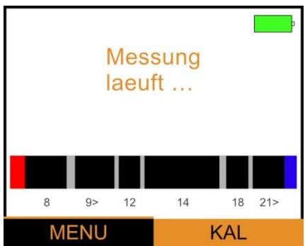
Setzen Sie daher immer mit dem Metall auf und z.B. nicht mit Steinen oder anderen nicht-leitenden Materialien. Mit der anderen Hand setzen Sie den Messstift an einer anderen elektrisch leitenden Stelle des Prüfobjektes auf. Drücken Sie leicht auf und schon startet die Messung automatisch – es erfolgt die Ausgabe „Messung läuft...“ (siehe Abbildung links). Warten Sie, bis die Messung abgeschlossen ist.
