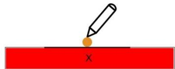
Asegúrese de que el lápiz de medición está insertado correctamente y hasta el fondo en el encaje ④. Ahora puede colocar la punta de medición lo más verticalmente posible sobre la pieza de calibración. La calibración se inicia automáticamente (figura arriba a la izquierda). Mantenga la punta sobre la pieza de calibración hasta que haya pasado la barra de progreso azul-gris. Si la calibración se realiza correctamente, aparece una barra verde con la indicación "OK" (figura central a la izquierda).
