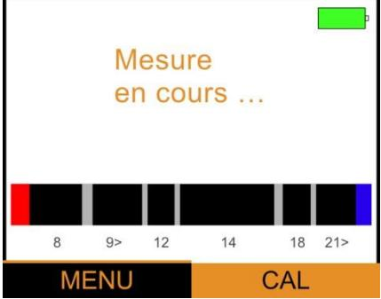
Avec l'autre main, placez le stylo de mesure sur un autre endroit conducteur de l'objet de test. Appuyez légèrement et la mesure démarre automatiquement - le message « Mesure en cours... » s'affiche. (voir illustration à gauche). Attendez la fin de la mesure.
