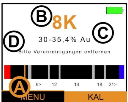
Das Ergebnis wird in Form von 3 Angaben ausgegeben (siehe Abbildung links): Der gelb-orangefarbene Cursor (A) blinkt auf der Messskala im Karat-Bereich des Prüfobjekts. Zusätzlich wird die Karatzahl in der Einheit „K“ (B z.B. 14K für 14 Karat) ausgegeben und darunter der entsprechende Bereich des Goldgehaltes in Prozent (C). Außerdem wird in manchen Fällen eine weitere Zeile mit Zusatzinformationen ausgegeben (D).
